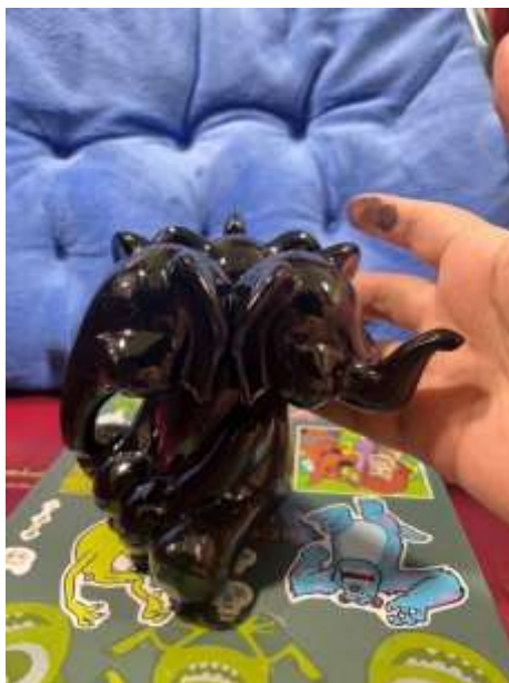
ชิ้นงานต้นแบบผลิตภัณฑ์เมื่อพ่นสีสเปรย์สีดำ และน้ำยาเคลือบเงาแล้ว
