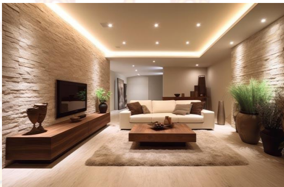
ภาพ 2.36 โคมไฟ Cove Lighting
