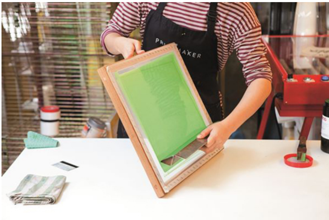
4. ใช้ยางปาดสีปาดทับที่เป็นลวดลายทั้งหมด กดน้ำหนักพอประมาณ 5. ปาดสีอีกครั้งโดยกดน้ำหนักให้แน่น
